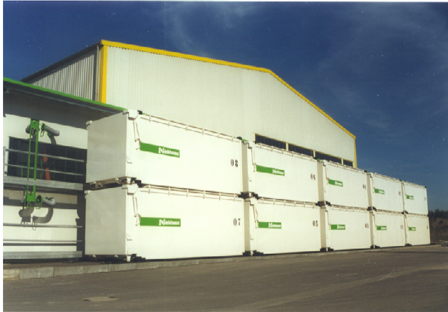
Abb. 2: Modular erweiterbare Container zur biologischen Behandlung von Restabfall (Systemgeber: Nehlsen AG, Bremen)
