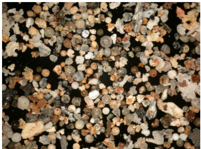
Abbildung 4 Kugelige und eckige Komponenten der Kesselasche. Die Salze der Probe wurden mit 3%iger \text{HNO}_3 ausgewaschen. (Bildbreite 2,8 mm).
