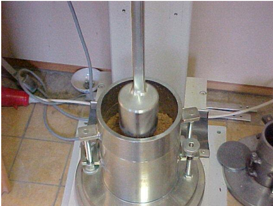
Abbildung 3-2: Versuchsaufbau beim Proctorversuch
